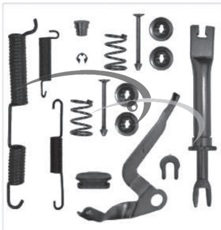
RT-553R Juego para freno de tambor der (17 pzas) Mazda Pick-Up B2200, B2600 94/96, balata 565 s/ajuste automatico
